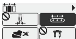
L'installation de l'aiguille double ne pourra se faire que si un programme prévu pour une aiguille double et la position centrale de l'aiguille ont bien été sélectionnés.
